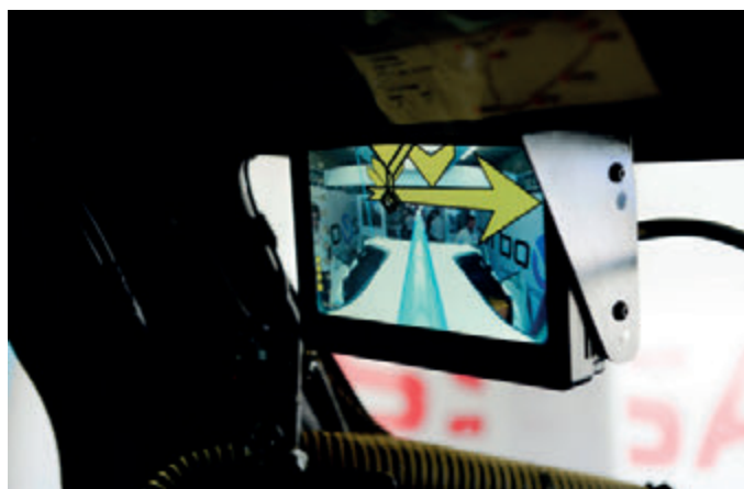
Šipky upozorňují na blížící se vůz i ze které strany se chystá předjíždět
