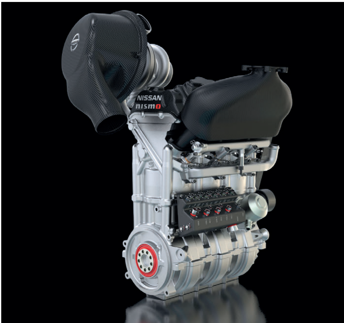
Přepíňovaný tříválec o objemu 1,5 litru má hmotnost pouhých 40 kilogramů a dokáže vyvinout výkon až 400 koní!
